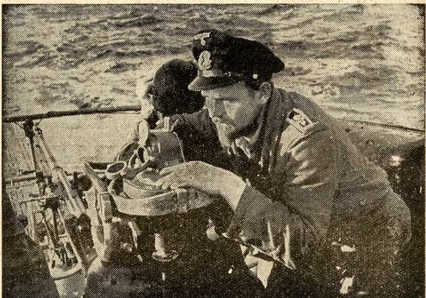
На отвореном мору положај подморнице се одређује по звездама помоћу секстанта. У близини обале то се врши по поморским ознакама на копну.
