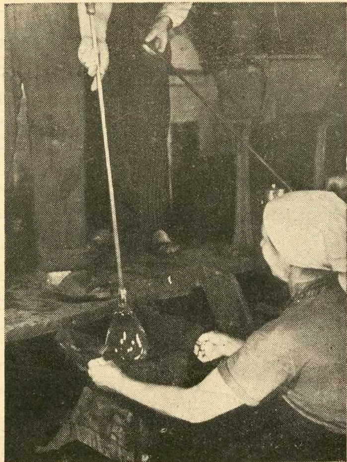
Десно — Дусање стакла је велика вештина. Кад стакло добије, услед дусања и обртања, крушкасти облик, спусти се у дрвени калуп где се охлади и прими коначну форму.
